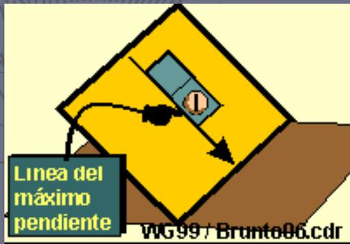
Medición de la dirección de inclinación máxima.
